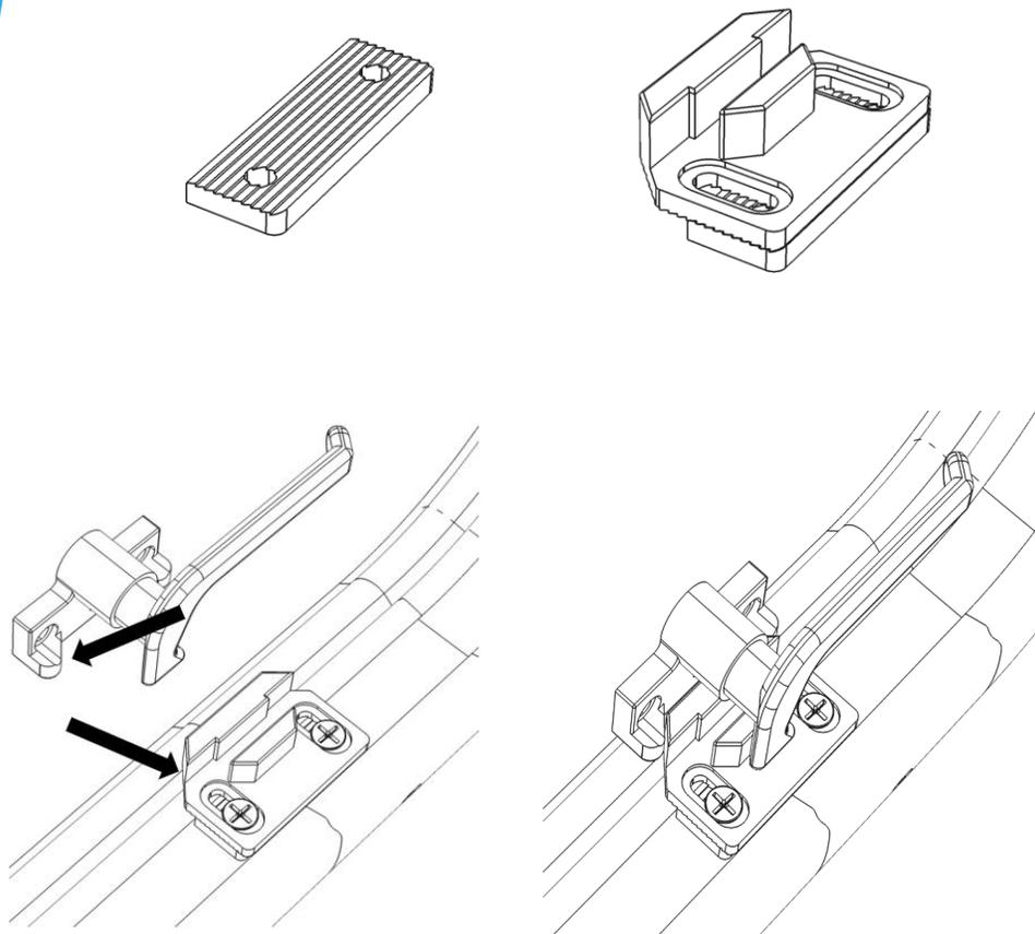
Achten Sie beim Einbau der Verschlussplatte auf ihre Ausrichtung an der Nut am Griff.
