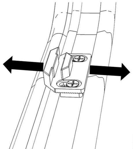
Jede Verschlussplatte hat Langlöcher, die eine einfache Einstellung ermöglichen: Lösen Sie die Schrauben, stellen Sie die Verschlussplatte ein und ziehen Sie die Schrauben fest.
