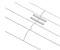
Diese zwei zusätzlichen Klammern sind nicht nötig, ob ein Butylband unter der Dichtungsfuge der Dichtung verwendet wurde.
