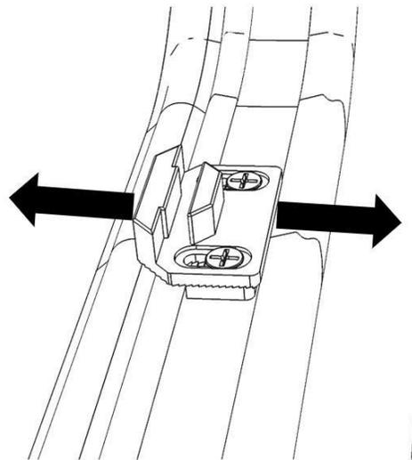
Die Lücke zwischen der Fahrzeugwand und dem Außenrand des Fensters muss genau 3 mm rundum sein. Wenn die Lücke uneben ist oder außerhalb der empfohlenen 3 mm liegt, überprüfen Sie die Positionierung der nahegelegenen Verschlussplatte.
