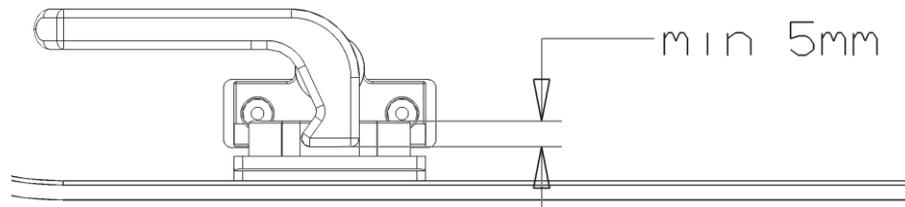
Die Überdeckung der Verschlussplatte und des Griffs sollte mindestens 5 mm betragen. Stellen Sie bei Bedarf eine zusätzliche Montageplatte unter die Verschlussplatte.
