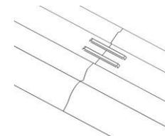
Diese zwei zusätzlichen Klammern sind nicht nötig, ob ein Butylband unter der Dichtungsfuge der Dichtung verwendet wurde.
