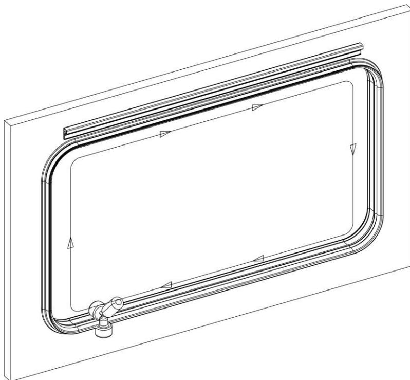
Drücken Sie nach dem Einbau der Dichtung die Außenseite (an der Stelle der Butylmasse) hart gegen die Fahrzeugwand.
