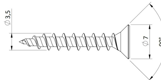
Die geeignete Länge der Schrauben muss vom Schraubenlieferanten bestimmt sein.
